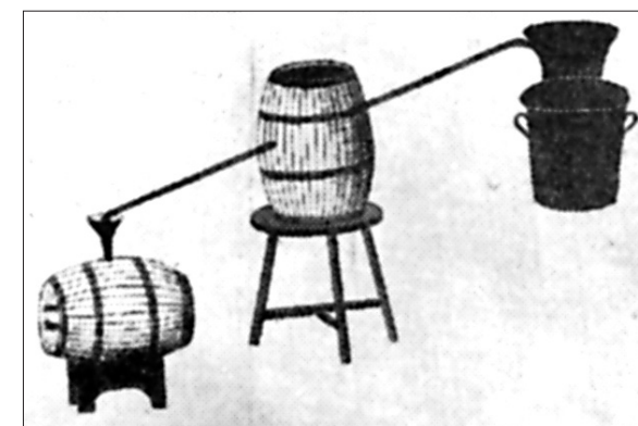
Tegning af et »Brændevinsredskab«. Til højre ses kobberkedel med hat og låg, alt af kobber. Derfra fører et langt rør »Piben« ind gennem svaletønne. Til venstre ses en tønne, hvori brændevinen løber ned.
