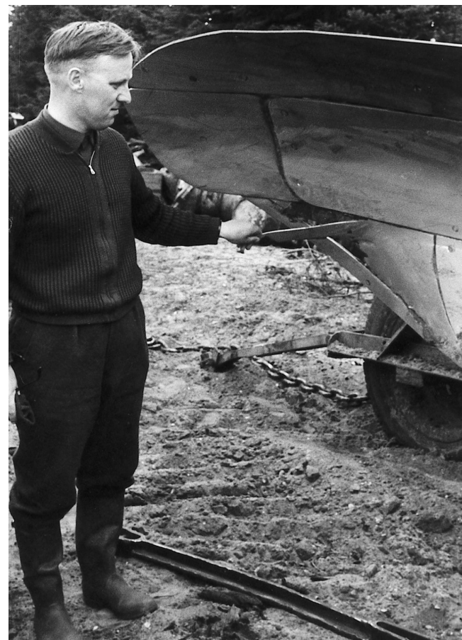
Skovfoged Henning Hvid Kristiansen ved den dybdepløj, der brugtes ved jordarbejdet forud for tilplantningen af det i 1967 brændte areal. Den formåede at nå 1 m i dybden, selv ved alforekomst i denne dybde. Af billedet kan man se, at muldfjælen blev tyndslidt, hvilket krævede hyppige udskiftninger.
