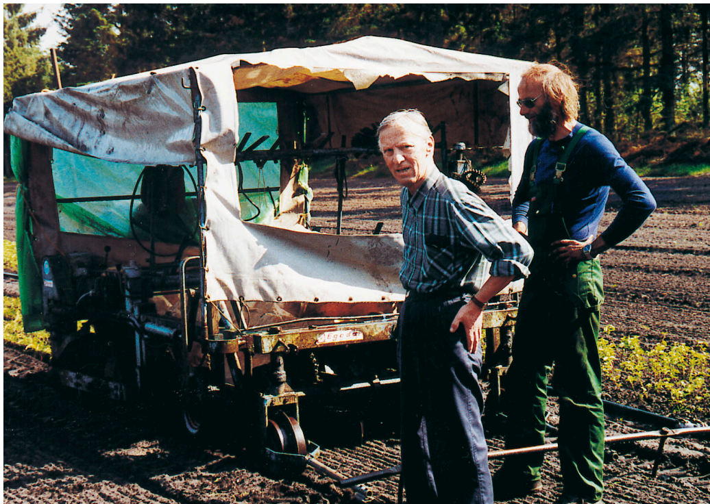
Plantetætheden i frøbede er sådan, at planterne for en del arters vedkommende omplantes til prikbejde, når de er én til to sæsoner gamle. Det sker med den viste selvkørende priklemaskine.
