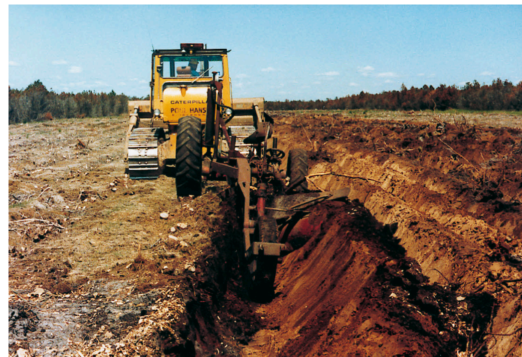
Dybdepløjning af tidl. bjergfyreareal med henblik på tilplantning med gran. Ploven nedpløjer alene bjergfyrstødene, idet stammer og grene er fliset til energiftis.
