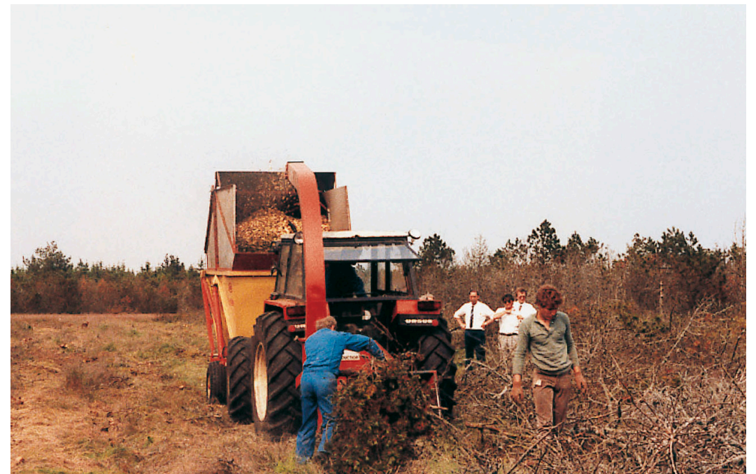
Flisning af bjergfyr med manuelt madet flishugger.
